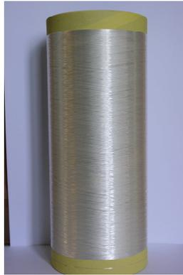
Abbildung 3. Doppelbindungsmodifiziertes Garn der Modifikation 3 (3%).
